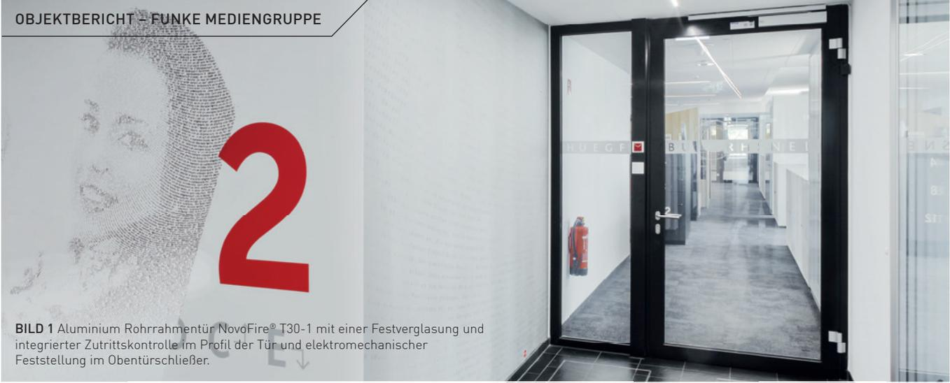
**BILD 1** Aluminium Rohrrahmen Tür NovoFire® T30-1 mit einer Festverglasung und integrierter Zutrittskontrolle im Profil der Tür und elektromechanischer Feststellung im Obentürschließer.
