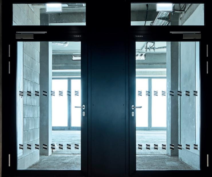
**BILD 1** NovoFire® Aluminium-Rohrrahmentür in der Ausführung T30-1 RS mit Rollenbändern und einem Seitenteil zwischen zwei Türen, um die Trennung zweier Büroeinheiten zu realisieren. Das Seitenteil ist mit einem Panel gefüllt und flächenbündig mit einem Blech verkleidet. Die Türen haben rechts und links eine Rahmenverbreiterung, damit die Tür über 90° geöffnet werden kann.
