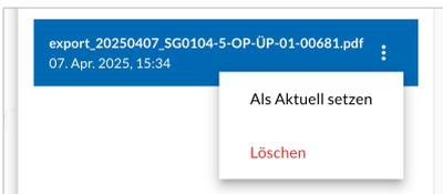
In der Liste der Vergleichspläne besteht über den Button die Möglichkeit, einen Vergleichsplan als „aktuell“ zu setzen. Damit wird der bestehende Plan gegen den neu hochgeladenen Plan ausgetauscht. Sämtliche Positionen und Inhalte (z.B. Maße) bleiben an der gleichen Stelle erhalten.
