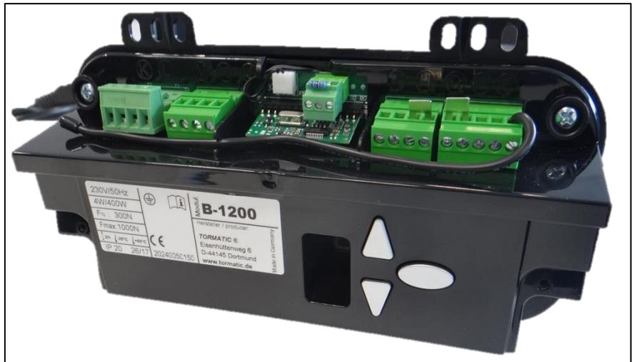
Die Anschlüsse für Zubehör, externe Beleuchtung und Sicherheitseinrichtungen befinden sich hinter der Frontabdeckung, wobei zwei Schrauben gelöst werden müssen.
