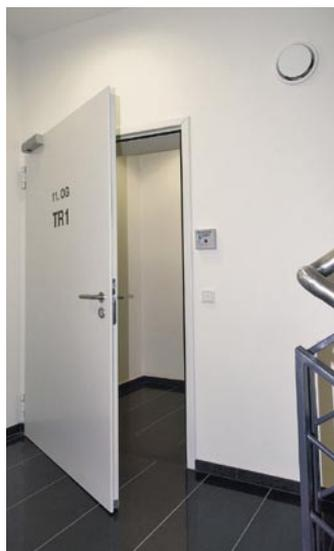
**Feuerschutztüren in Normausführung:** Hier kann Novoform Riexinger auf eine breite Palette zugelassener Abschlüsse sowohl in T30- wie in T90-Ausführung zugreifen. Kostenvorteile durch rationelle Serienfertigung kommen den Kunden zugute. Auch bei Normtüren sind viele Anforderungen, z. B. an Verglasung und Ausstattung, innerhalb der Zulassung möglich.
