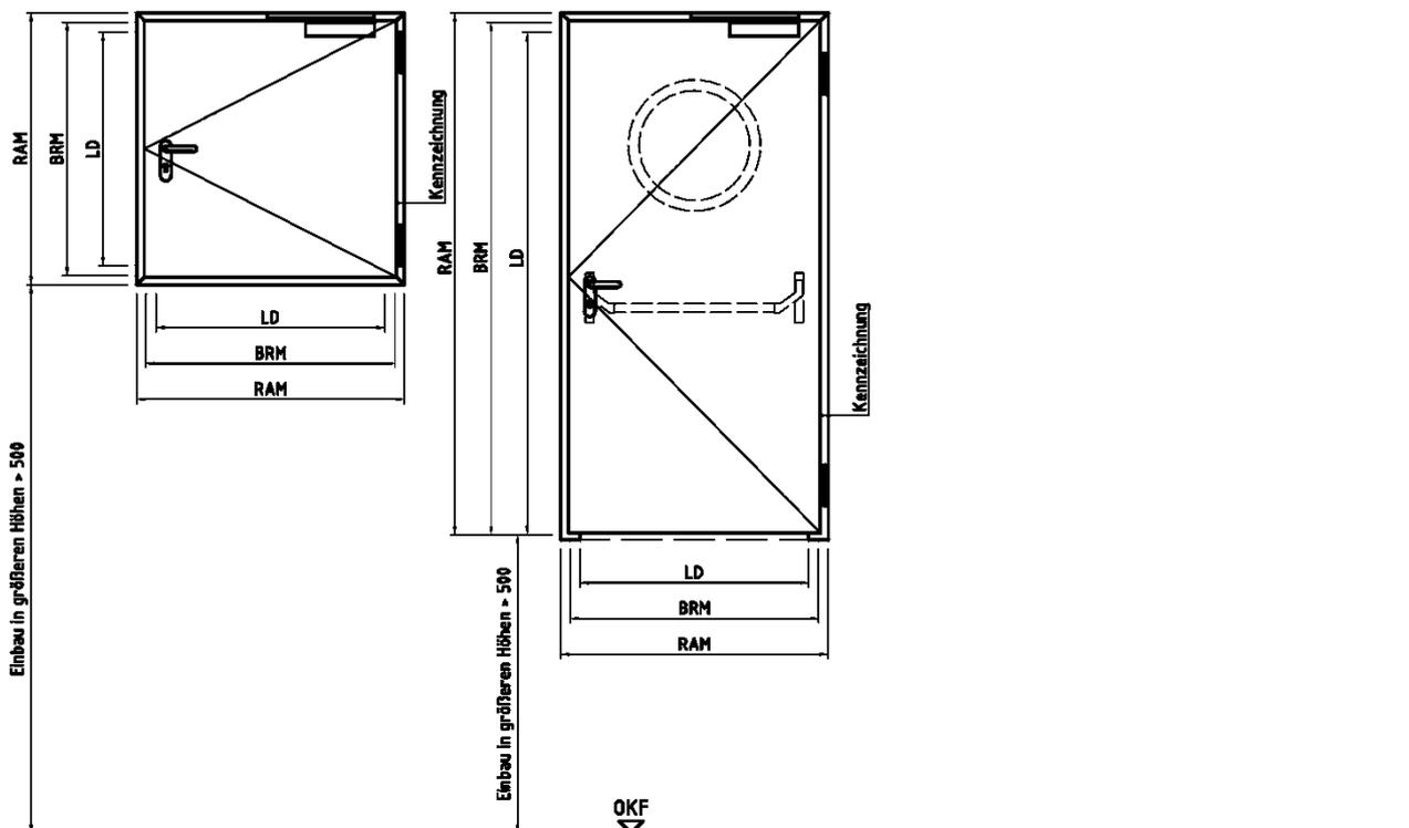
T 90-1-RS-FSA "Typ NovoPorta Premio" immer mit zusätzlicher unterer Bodendichtung oder 4-seitige Dichtung ausführen. Bei Wandanschluss mit Mörtel hinterfüllung ohne Versiegelung, ansonsten mindestens einseitig dauerelastisch versiegeln!
