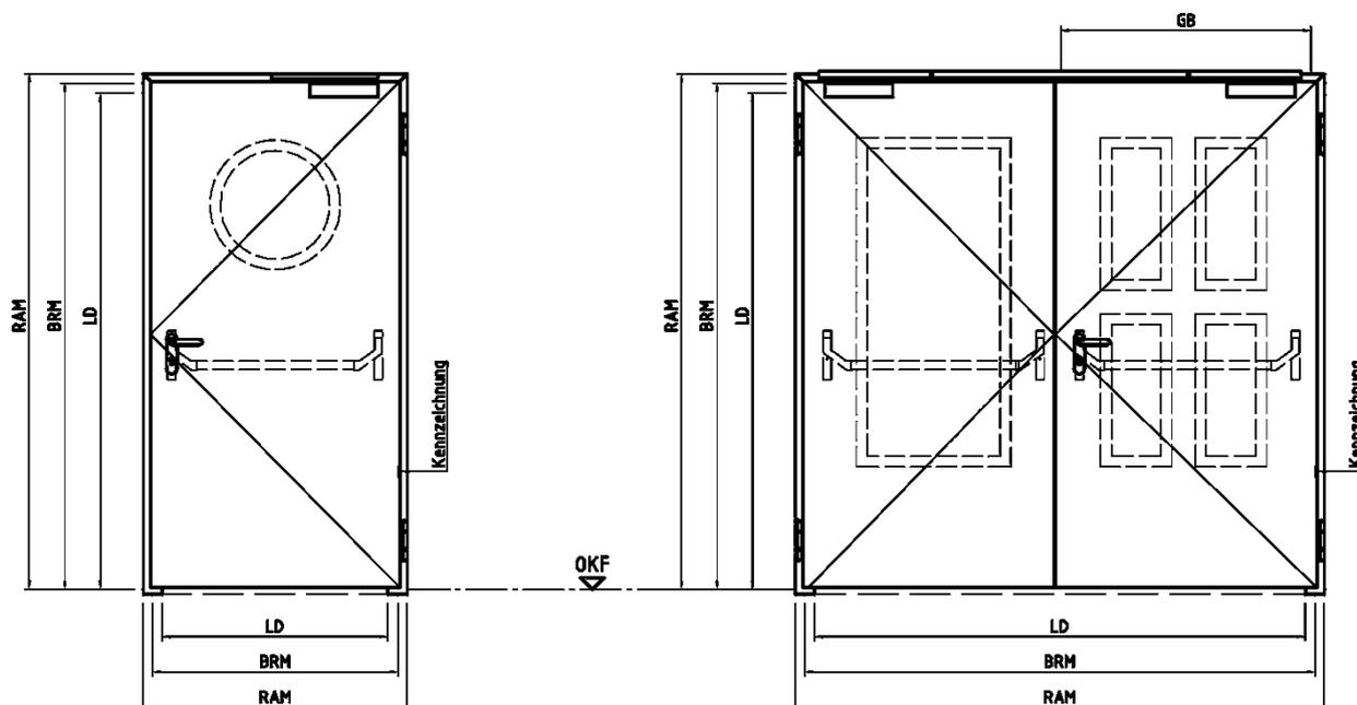
T 90-1-RS-FSA "Typ NovoPorta Premio" und T 90-2-RS-FSA "Typ NovoPorta Premio" immer mit zusätzlicher unterer Bodendichtung oder 4-seitige Dichtung ausführen. Bei Wandanschluss mit Mörtel hinterfüllung ohne Versiegelung, ansonsten mindestens einseitig dauerelastisch versiegeln!
