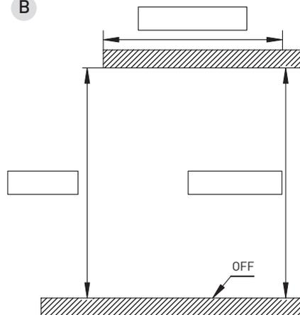
\* Wenn Sie über zusätzlichen Platz im Sturzbereich verfügen, positionieren Sie die Unterseite des Kastens 100 mm über dem Sturz, um die letzte Lamelle zu verdecken. So steht Ihnen die gesamte Öffnung in der Höhe zur Verfügung.
